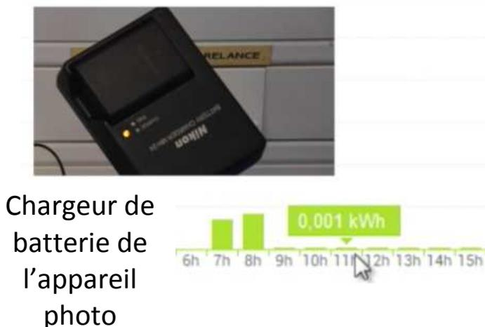
Par ces mesures, nous faisons apparaître l'existence d'un gaspillage électrique lorsque les récepteurs restent sous tension alors qu'ils sont chargés.
